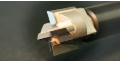
Fresa para cajea con la punta de carburo
