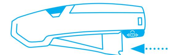
Después de cortar desplace el seguro **a la posición de adelante** para fijar la palanca. De este modo, la hoja permanece dentro del mango de forma segura.
