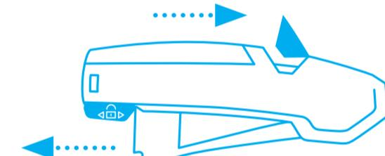
Desplace el dispositivo de seguridad hacia la posición trasera para que la palanca pueda soltarse nuevamente. **Luego** vuelva a introducir en el mango el botón de cambio de cuchilla, y siga cortando.
