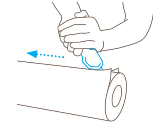
Para **cortes de fuerza** presione la palanca y corte tirando. Añada la segunda manecilla para reforzar el corte.
