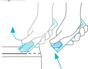
**Retracción automática de la hoja: alto grado de seguridad**
